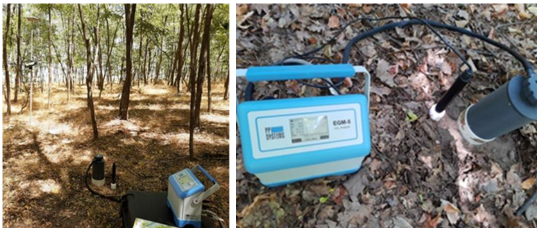
Măsurătorile efectuate în zona de studiu Hobana, Ocolul Silvic Grivița, Direcția Silvică Galați (pădure de Salcâm) –aparatura utilizată (analizorul portabil folosit pentru determinarea fluxului de CO 2 , GPS GNSS – Leica Viva GS08+)
